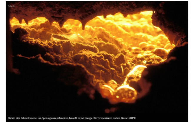
Blick in eine Schmelzwanne: Um Spezialglas zu schmelzen, braucht es viel Energie. Die Temperaturen reichen bis zu 1.700 °C.
