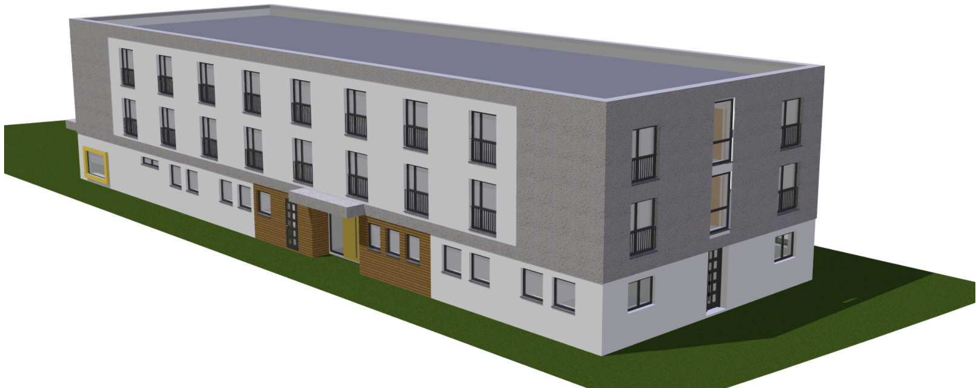
Studentenwohnheim mit 36 WE und Kita, Rüsselsheim – PV-ISIeTherm mit SW-Wp und Redundanz Brunnen
