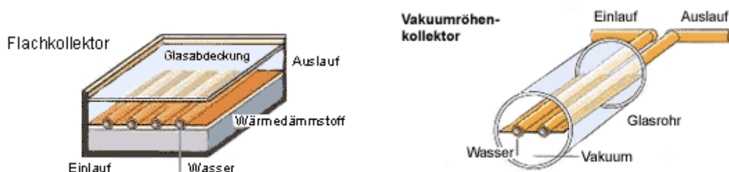
Abbildung 2-5 Flachkollektor und Vakuum-Röhrenkollektor (Quelle: Solarserver)
