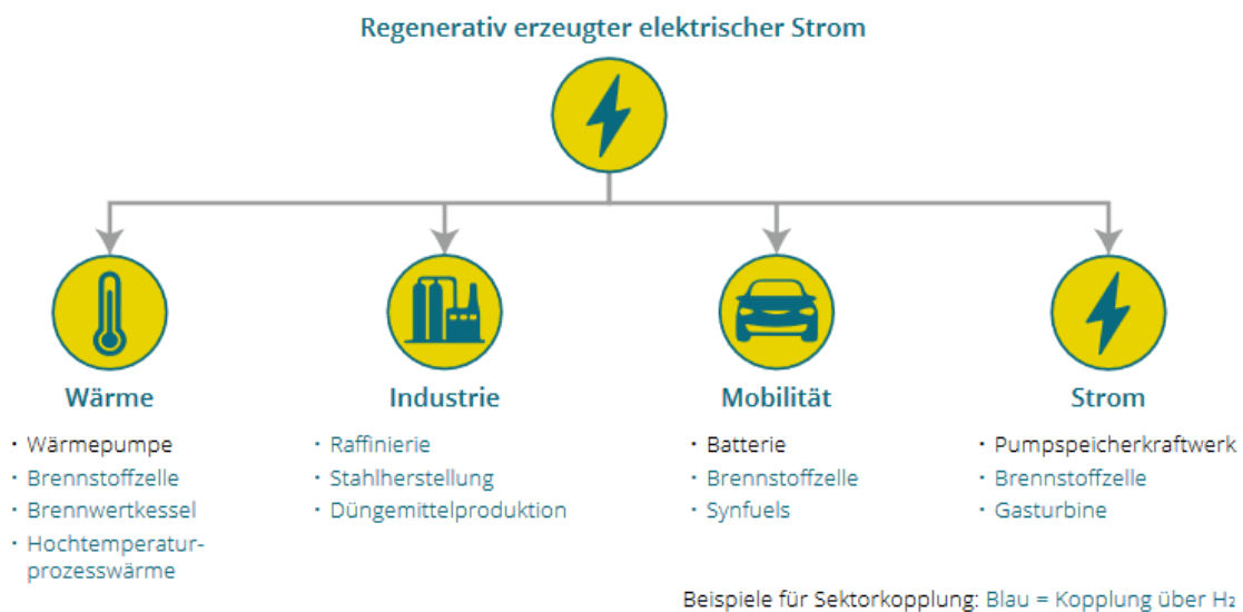
Abbildung 2-2: Dekarbonisierung über den Stromsektor bzw. die Sektorkopplung mit Wasserstoff als Bindeglied (Quelle: (Zentrum Wasserstoff Bayern (H2.B), 2020))
