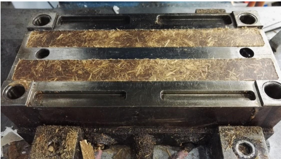
Abbildung 15 Prüfkörper (Verbundwerkstoff) aus HBS/Apyrum/PTP
