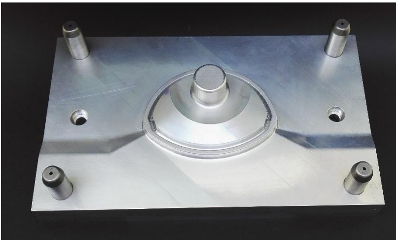
Abbildung 37 Stempel des Endkappen Werkzeugs
