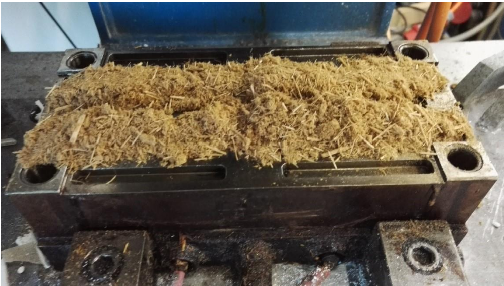
Abbildung 14 Verarbeitung des Halbzeugs HBS/Apyrum/PTP
