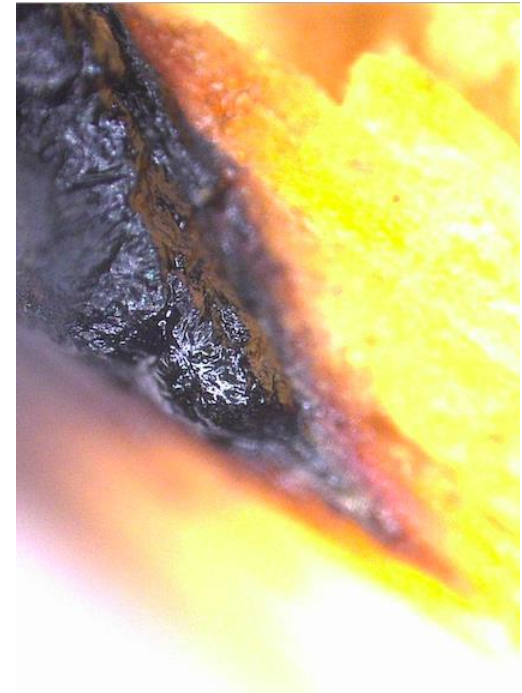
mikroskopische Aufnahme der Verkohlung
