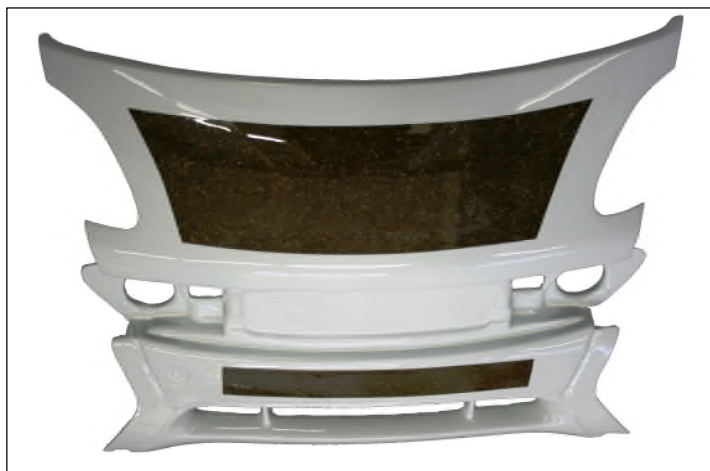
Der erste Schritt zu einem neuen Werkstoff für Außenteile von Autos: Das Integralbauteil „Haube und Frontpartie“ des Smart Fortwo wurde an der FH Bingen vollständig aus biogenem Duroplast hergestellt. Die wichtigsten Eigenschaften dieses Stoffes sind der hohe Anteil nachwachsender Rohstoffe, die niedrige Dichte und äußerst niedrige organische Emissionen. In der Mitte: Die dunkle Fläche zeigt das verwendete Flachs/Hanf-Vlies mit transparenter Lackierung. Bild: FH BIN
